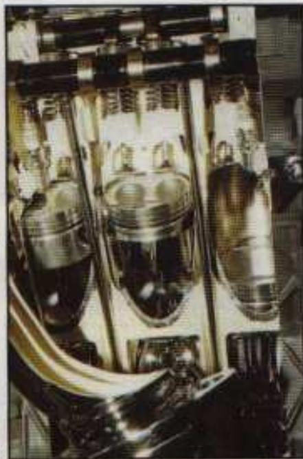
**4. Les pistons comportent un bossage qui permet un rapport volumétrique de 9,5, malgré un angle de soupapes relativement élevé (45°).**
