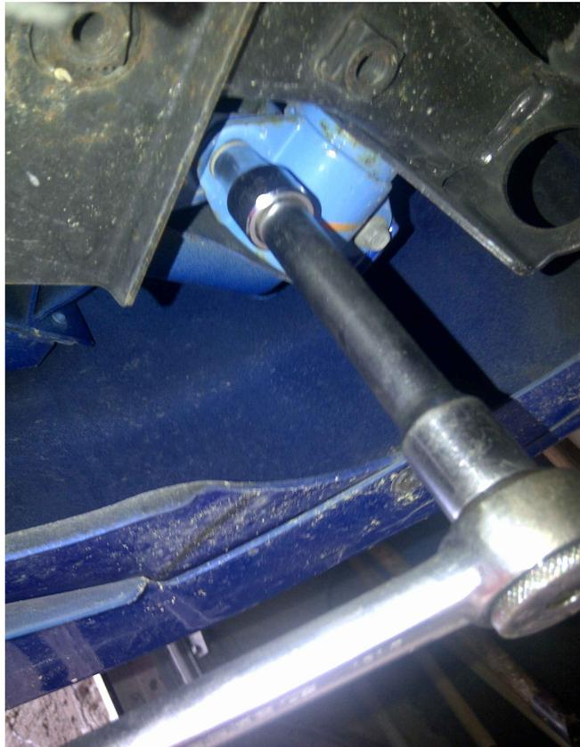
Puis avec la douille de 17 retirer les 3 (X2) vis maintenant à l'arrière le faux châssis à la caisse.
