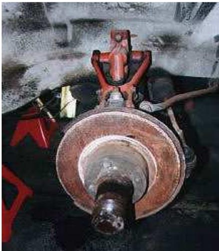
**L'étrier de frein a été entièrement retiré car il avait besoin d'être reconditionné. Si vous n'avez pas l'intention de perturber votre système de freinage il doit être dégagé de l'espace de travail et posé sur un support de façon à n'exercer aucune tension ou torsion sur la durite**
