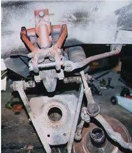
**Ensuite la jonction inférieure de la fusée peut être démontée en l'ensemble moyeux fusée mis de côté**
