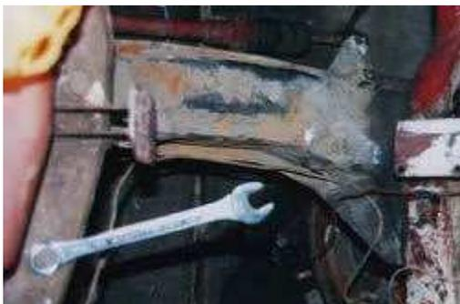
Il ne reste plus qu'à défaire les quatre gros boulons qui relie la traverse au châssis en prenant la précaution de mettre un cric en dessous pour la déposer en toute sécurité
