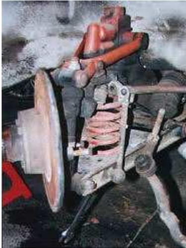
**En suivant on détache la barre anti-roulis de sa biellette, on desserre aussi la de fixation de la biellette au bras d'articulation inférieur, mais on ne l'enlève pas encore**
