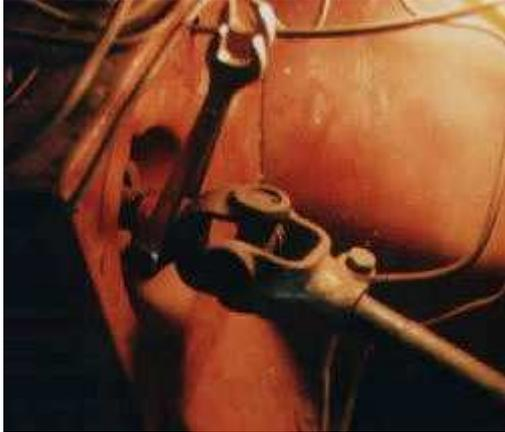
On défait et retire complètement le boulon supérieur du cardant de direction pour le désolidariser de la partie supérieure de la direction qui pourra ainsi être démontée plus facilement si nécessaire
