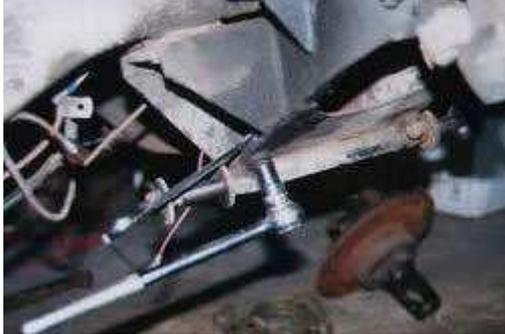
**L'axe de bras d'articulation peut alors être retiré en en défaisant quatre boulons**
