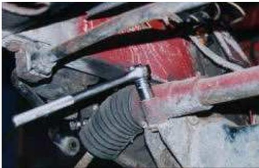
Déposer le boîtier de direction consiste à défaire quatre boulons.
