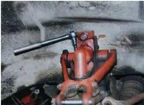
**Quatre boulons aussi pour retirer l'amortisseur**
