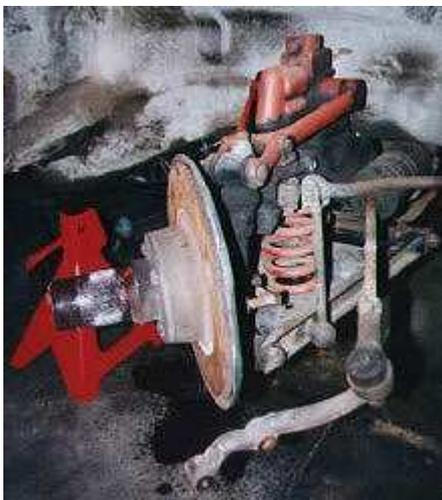
**Excepté si la rotule de direction doit être remplacée, le plus simple maintenant est de désolidariser le bras de direction de la fusée et de le dégager de l'espace de travail.**
