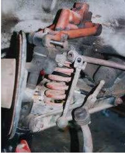
**Remarquez que le cric a été placé sous l'axe inférieur de fusée de façon a maintenir la pression sur le ressort et ainsi éviter une sauvage agression des zones précieuses de votre anatomie lors de l'enlèvement du pivot**
