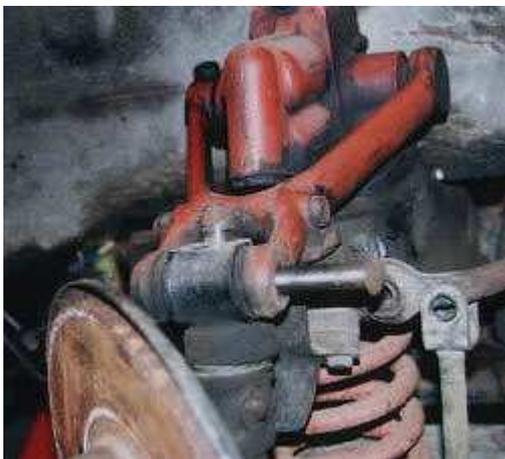
**Quand la première méthode a échoué, on monte le cric jusqu'à ce que le bras d'amortisseur commence à monter de façon à éliminer toute tension sur l'axe d'articulation qu'on extrait de sont logement à l'aide d'un chasse goupille et d'un gros marteau.**
