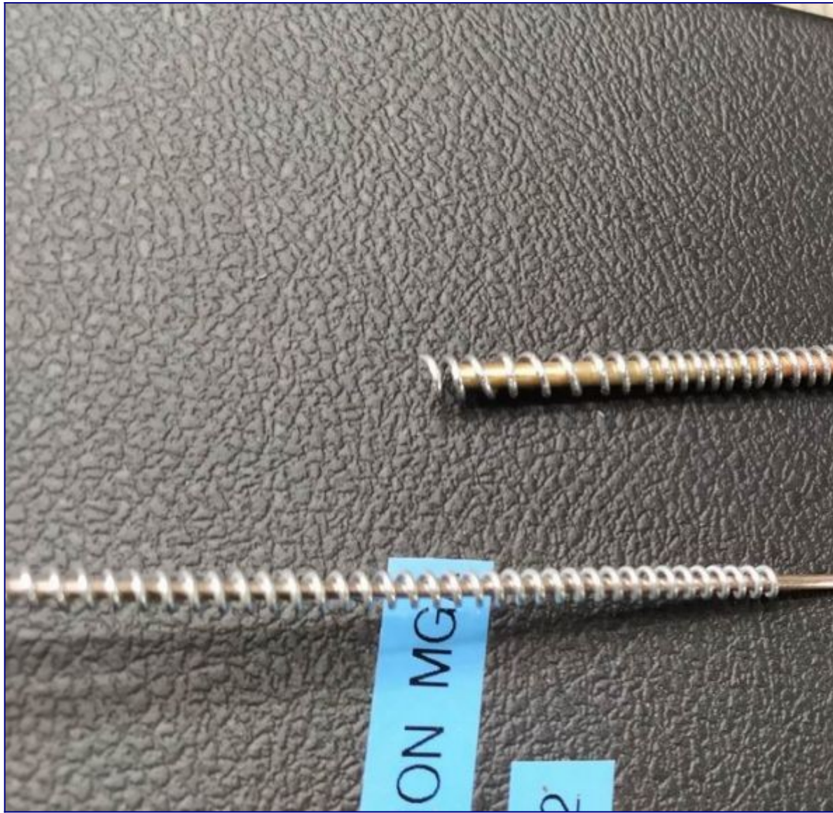
Fabrication d'un ressort de protection sur mesure
